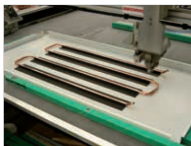
Montagem em fábrica das placas radiantes metálicas
